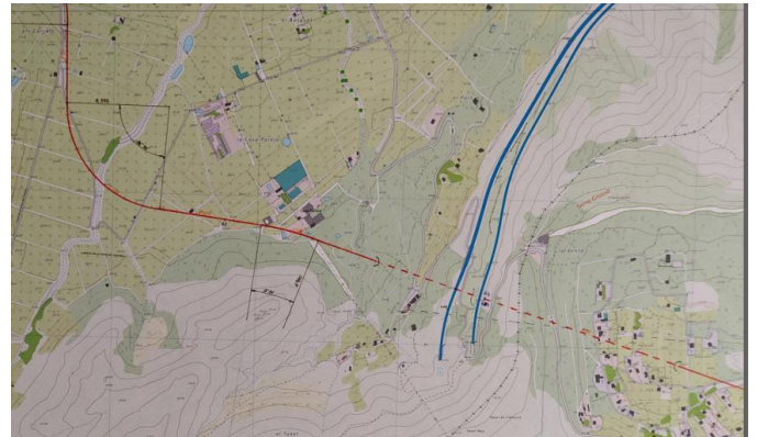
Imatge 10: Traçat de la línia amb el túnel sobre mapa 1/5000 de l'ICV. Elaboració pròpia.
