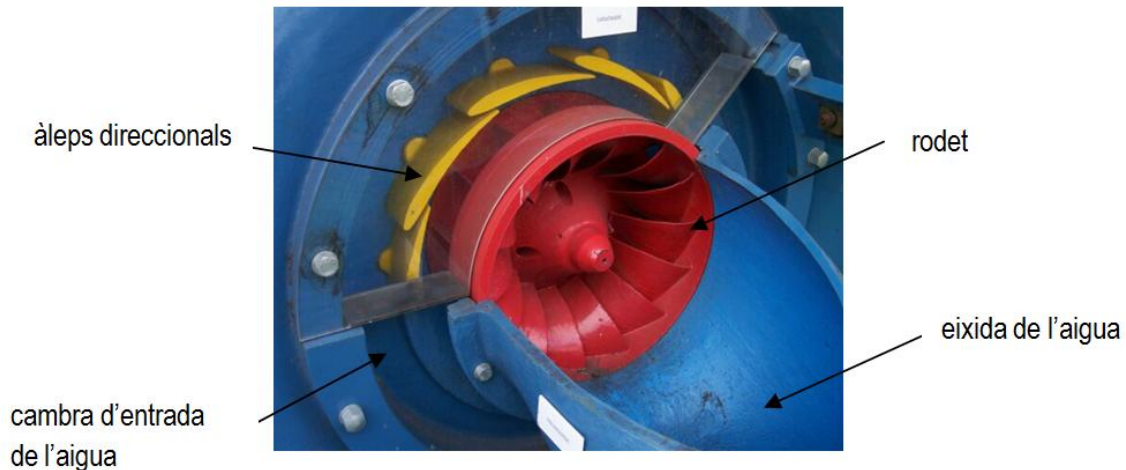
Imatge 32: Turbina Francis seccionada
