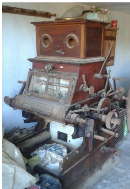
Imatge 58: Màquina de cilindres del Molí Vell Font: Foto cedida per Xavier Ferrero
