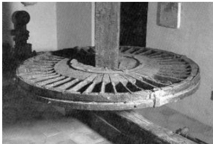
àleps corbats o en forma de cullera. A la imatge 27 es Imatge 28: Rodet amb àleps de fusta Font: Fábricas hidráulicas españolas
